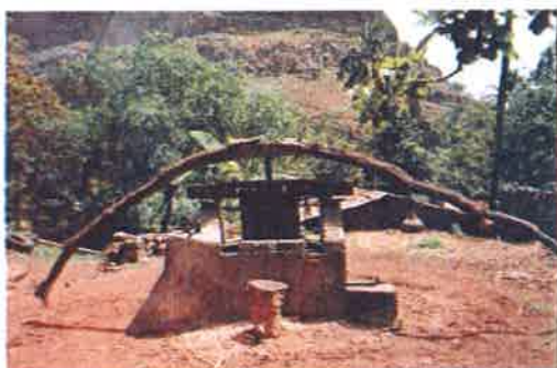
Trapiche de três cilindros verticais Ilha de Santo Antão, Cabo Verde
